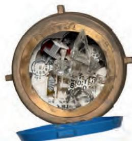
2. geplatzt Glas und zerstörtes Zählwerk
