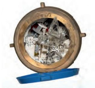
2. geplatzt Glas und zerstörtes Zählwerk
