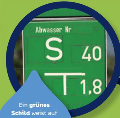
Ein **grünes Schild** weist auf eine weitere Armatur hin, genauer gesagt auf eine, die an einer **Abwasserdruckleitung** liegt.
